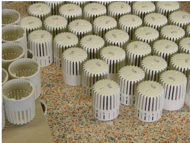
Montage Handrädern für Thermostatventile
