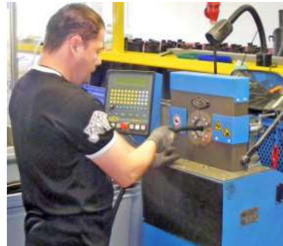
Verpressen der Anschlussarmaturen
