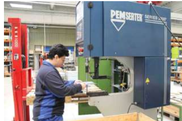
Einpressgerät für Bolzen und Muttern
