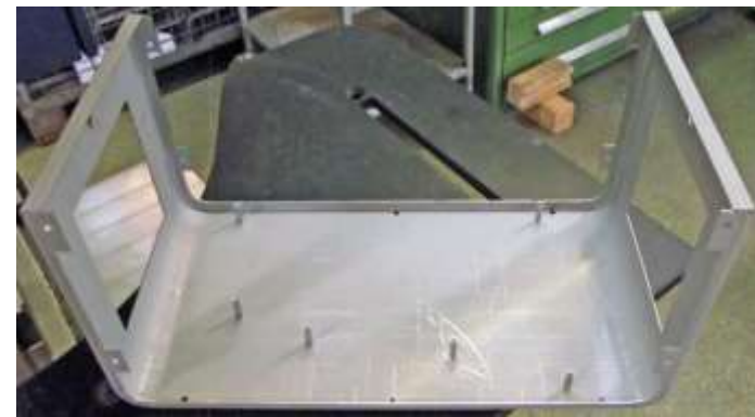
Arbeitsgang „Bolzen pressen“
